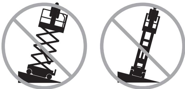
Не полагайтесь на звуковой сигнал предупреждения как указание уровня. Звуковой сигнал предупреждения включается на ходовой части и на платформе, только если машина оказывается на крутом склоне.
